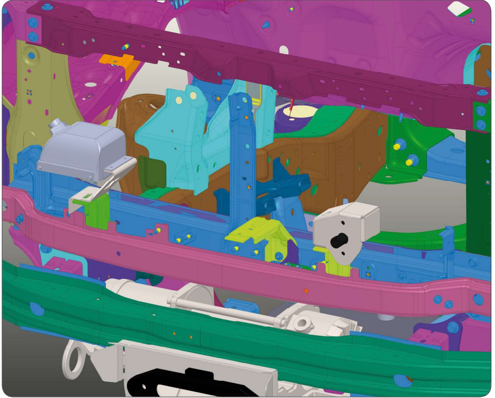
Abb. 22: Montage der Steuerbox und des Notaushalters | mounting of the controlbox and the power switch
