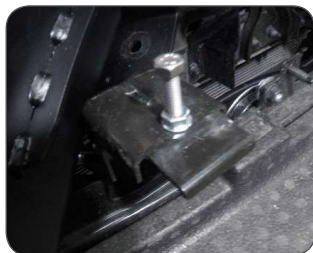
Abb. 13-15: Gewindeniet setzen | mount a rivet nut
