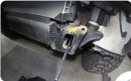
Abb. 08: Rahmeneinschub HSW9900XBD_X_11 im Rahmen | HSW9900XBD_X_11 inserted in the frame
