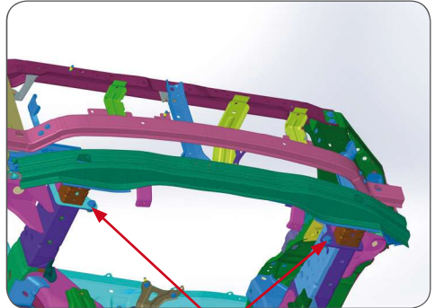
Abb. 06: untere Verschraubung des Rahmens | lower mountings of the crossmember
