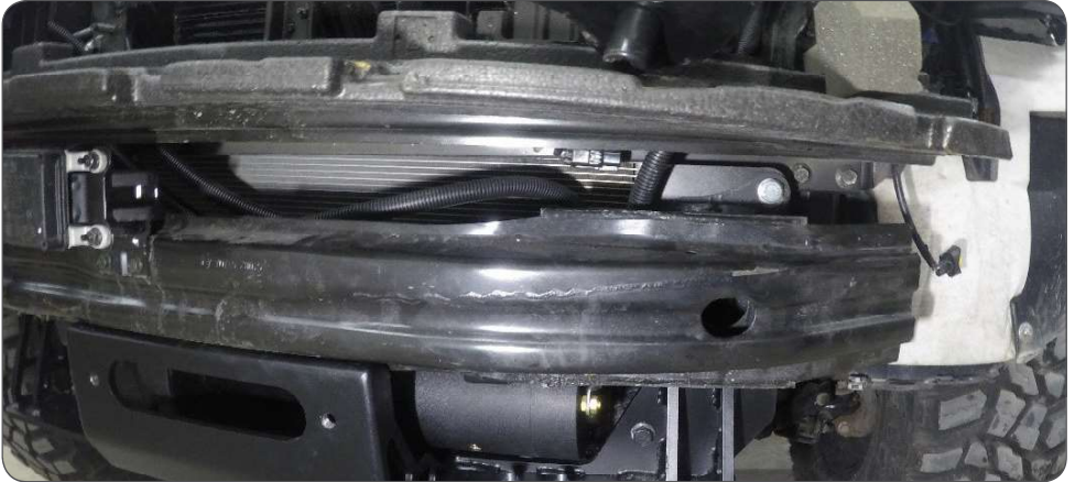
Abb. 16: Vorderer Querträger wieder montiert | front crossmember attached to the winch carrier
