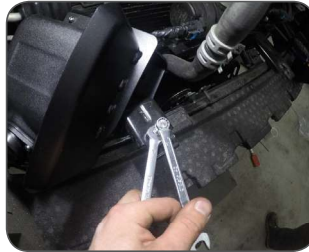
Abb. 10-12: Gewindeniet setzen | mount a rivet nut
