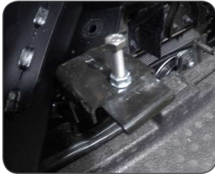
Abb. 10-12: Gewindeniet setzen | mount a rivet nut
